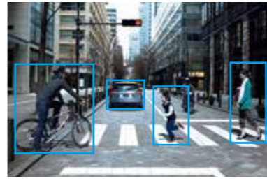
街中での障害物の認識イメージ ※認識対象は高さ1m以上。
