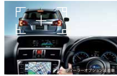
カラー画像化により、先行車のブレーキランプを認識
