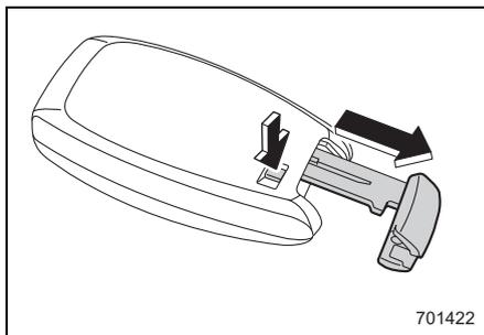
メカニカルキーを確実に差し込んでお車の後ろ側に回すと解錠され、前側に回すと施錠されます。メカニカルキーは差し込み方向に指定のある内溝キーです。差し込めない場合は向きを改めて差し込んでください。
