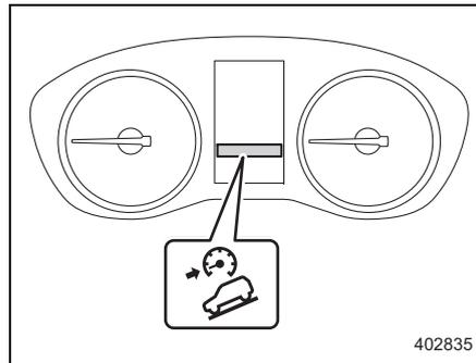
マルチファンクションディスプレイを予防安全画面にしている場合、メーター内の表示灯に連動してヒルディセントコントロール作動表示が点灯・点滅します。
