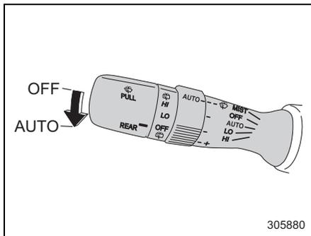
リングを回すと、雨滴量に反応するセンサーの感度を次のように調整できます。
