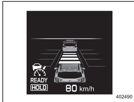
先行車の有無にかかわらず、自車の停止中にブレーキペダルを強く踏むと“READY”（READY表示灯）が点灯します。このときRES/+スイッチ、SET/-スイッチを操作すると停止保持を開始します。
