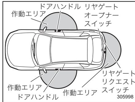
ドアが施錠している状態で前席のドアハンドルの作動エリアに入ると、アクセスキーのLEDの表示灯が点滅します。キーレスアクセス機能を停止させている場合は、アクセスキーのボタンを押さないとLEDの表示灯は点滅しません。
