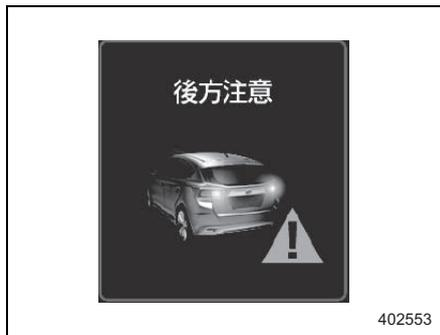
システムによるブレーキで停車した後は、安全のためブレーキペダルを踏んでください。ブレーキペダルを踏むまでマルチファンクションディスプレイとマルチインフォメーションディスプレイに割り込み画面が表示され、警報音が鳴ります。
