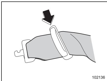
3. 図のようにタングプレートを格納ホルダーに差し込み固定します。
