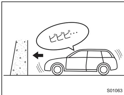
AT誤発進抑制制御が作動するとブザー（ピピピ…）が鳴り、マルチインフォメーションディスプレイに割り込み画面を表示します。
