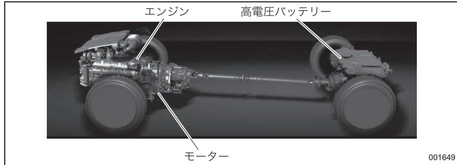
アクセルペダル、ブレーキペダルの操作や車速など、車の状況に合わせて、エンジンは自動的に停止・再始動します。
