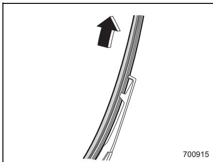
4. ワイパーブレードに新品のブレードラバーを挿入します。このとき、ブレードラバーの溝部にワイパーブレードのツメ部が挿入されていることを確認します。適切に装着されていないとワイパー作動時、ガラス面に傷をつけるおそれがあります。
