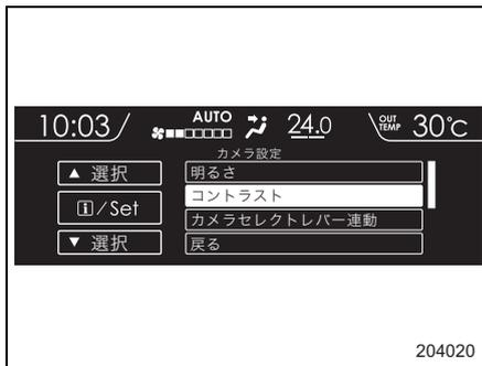
2. ▲ (戻し) ▼ (送り) スイッチを操作してコントラストを調整し、**i** (インフォメーション) / SET スイッチを引いて決定します。決定すると項目選択画面に戻ります。
