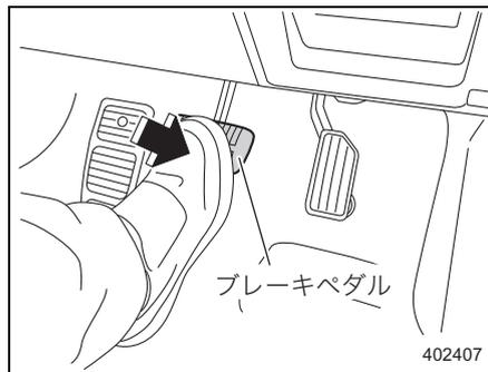
2. ブレーキペダルを確実に踏んだまま、プッシュエンジンスイッチを押します。エンジンが始動するまでブレーキペダルを踏み続けてください。
