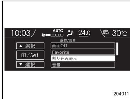
2. ▲ (戻し) ▼ (送り) スイッチを操作して表示を変更したい項目を選択し、**i** (インフォメーション) / SET スイッチを引いて決定します。
