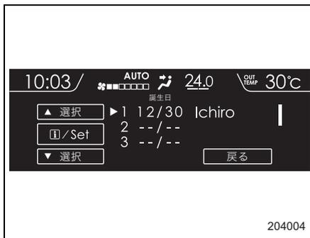
3. 設定する項目を▲(戻し)▼(送り)スイッチを操作して選択し、**i**(インフォメーション) / SETスイッチを引いて決定します。
