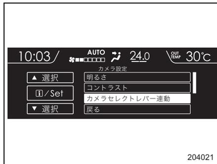
2. ▲ (戻し) ▼ (送り) スイッチを操作して「ON」または「OFF」を選択し、**i** (インフォメーション) / SET スイッチを引いて決定します。
