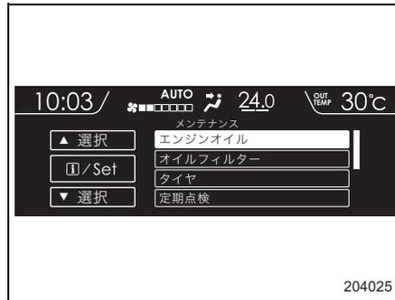
2. 設定する項目を▲（戻し）▼（送り）スイッチを操作して選択し、**i**（インフォメーション） / SETスイッチを引いて決定します。
