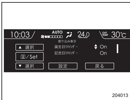
4. 設定が終了したら▲ (戻し) ▼ (送り) スイッチを操作して「設定」を選択し、**i** (インフォメーション) / SETスイッチを引いて決定します。
