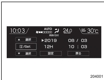
3. ▲ (戻し) ▼ (送り) スイッチを操作して数字を切り替え、**i** (インフォメーション) / SET スイッチを引いて決定します。決定すると手順 2. の表示に戻ります。
