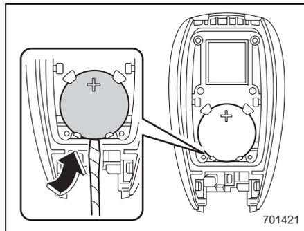
4. 新しい電池のプラス極を上にして図のように挿入し、確実に取り付けます。
