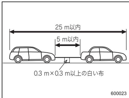
4. 電動パーキングブレーキを解除し、けん引します。けん引中は、前の車の制動灯に注意してロープをたるませないようにしてください。
