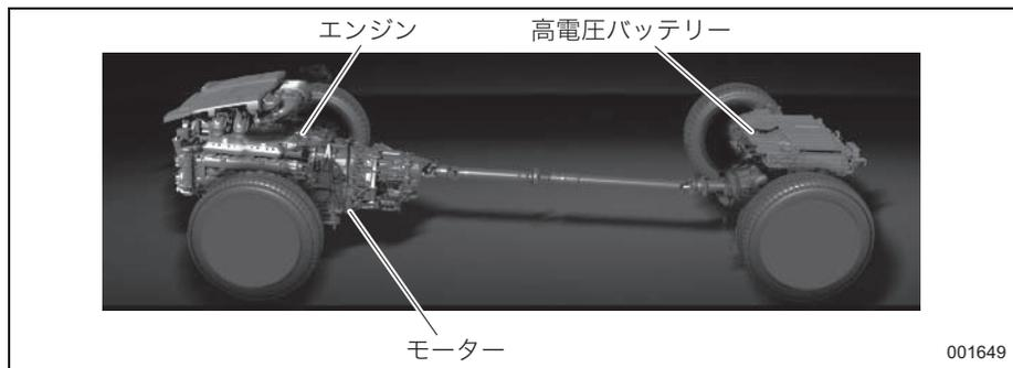
アクセルペダル、ブレーキペダルの操作や車速など、車の状況に合わせて、ガソリンエンジンは自動的に停止・再始動します。
