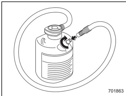
16. パンク修理キットを車両に搭載して直ちに走行します（10分間または5km程度）。走行は法定速度を守って、80km/h以下の速度で急ハンドルなどを避け、慎重に運転してください。
