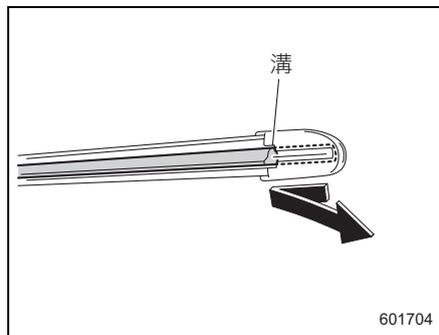
3. 新品のブレードラバーを挿入します。このとき、ブレードラバーの溝を間違えないように挿入してください。
