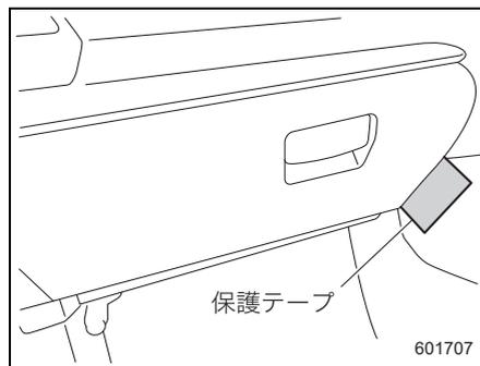
2. グローブボックスから、グローブボックスを固定しているダンパーを引き抜いて取り外します。
