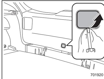
2. マイナスドライバーなどを使用してレバーを矢印の方向に動かし、リヤゲートを開けます。
