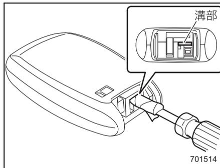
3. 電池と基板の間に絶縁テープなどを巻いたマイナスドライバーを差し込んで、電池の上側を押さえながら電池を抜き取ります。
