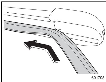
4. 矢印の位置までブレードラバーを押し込み、先端を元の位置に戻します。
