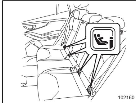
チャイルドシートを取り付けるときは、カバー裏の矢印が見えなくなるまで完全に押し込みます。
