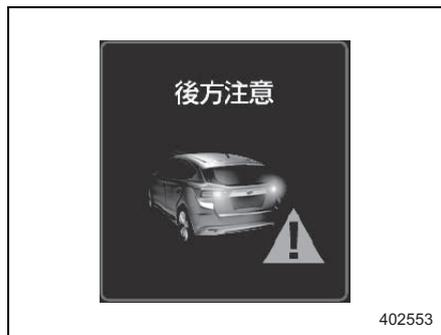
システムによる自動ブレーキで停車した後は、安全のためブレーキペダルを踏んでください。ブレーキペダルを踏むまでマルチファンクションディスプレイとマルチインフォメーションディスプレイに割り込み画面が表示され、ブザー（ピー——）が鳴ります。
