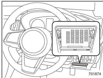
取り付けるときは、上側の突起部を先に入れてから、下側のツメを確実に合わせて取り付けます。
