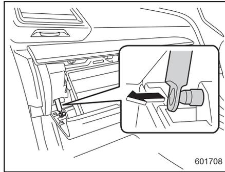
3. グローブボックスの両側面を内側に押し込んでストッパーを外し、グローブボックスを引き下げ、水平近くまで開いてからグローブボックスを取り外します。
