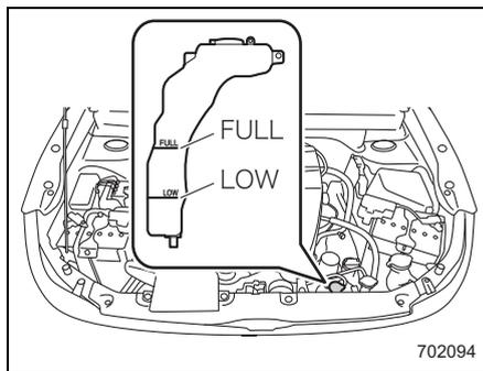
5. ラジエーターキャップを開け、冷却水を補給してください。
