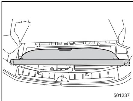
カーゴルームのリッド (フタ) を元の位置に戻すとき、ストラップをフックにかけてスカートトリムに固定します。
