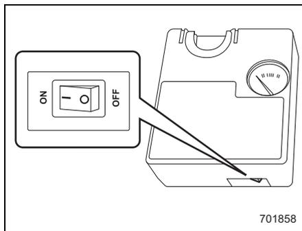
23. タイヤの空気圧が黄色のゾーンのときは、タイヤの指定空気圧まで空気を入れます。
