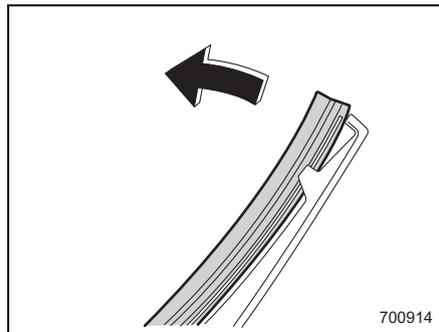
3. ワイパーブレードからブレードラバーを引き抜きます。
