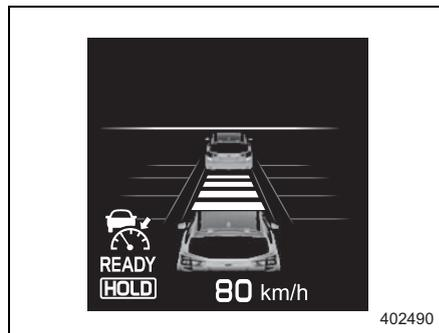
先行車の有無にかかわらず、自車の停止中にブレーキペダルを強く踏むと“READY”（READY表示灯）が点灯します。このときRES/+スイッチ、SET/-スイッチを操作すると停止保持を開始します。
