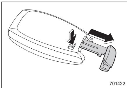
メカニカルキーを確実に差し込んでお車の後る側に回すと解錠され、前側に回すと施錠されます。メカニカルキーは差し込み方向に指定のある内溝キーです。差し込めない場合は向きを改めて差し込んでください。
