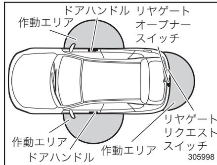
ドアが施錠している状態で前席のドアハンドルの作動エリアに入ると、アクセスキーのLEDの表示灯が点滅します。
