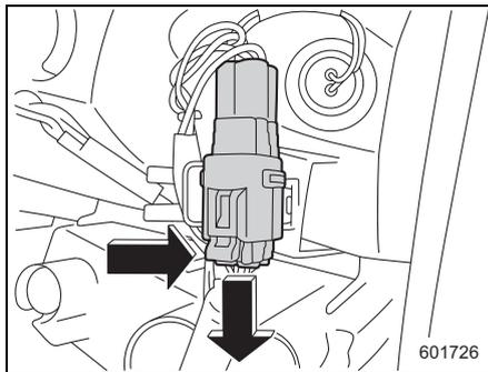
4. 切れている電球のソケットを反時計回りに回し、ソケットを引き抜きます。
