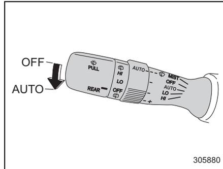
リングを回すと、雨滴量に反応するセン
