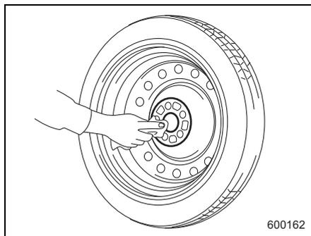
13. ホイールナットを手で回して取り付けます。その後ホイールがガタつかない程度までホイールナットをホイールナットレンチで仮締めします。
