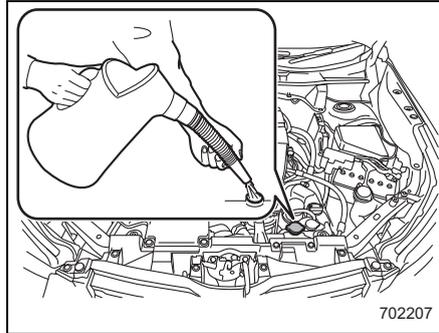
冷却水は注入口の口元（イラストの(1)の位置)まで補給します。
