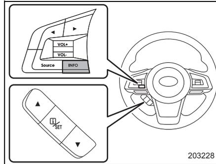
2. ▲ (戻し) ▼ (送り) スイッチを操作して設定メニューを切り替えます。
