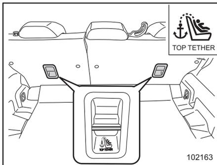
テザーベルトのフックを、図のようにトップテザーアンカレッジに引っかけます。
