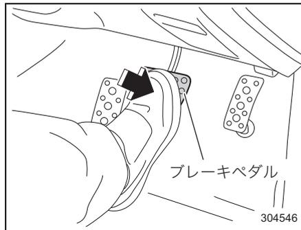
4. ブレーキペダルを確実に踏んだまま、プッシュエンジンスイッチを押します。エンジンが始動するまでブレーキペダルを踏み続けてください。e-BOXERシステムが作動すると、メーター内の走行可能 (READY) 表示灯が点灯します。
