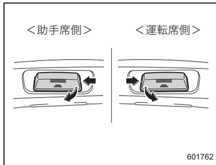
2. ソケットを反時計回りに回し、ソケットを引き抜きます。
