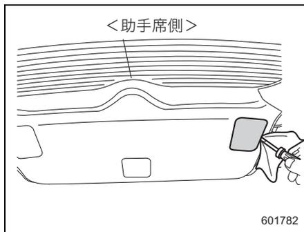
3. ソケットを運転席側は反時計回りに、助手席側は時計回りに回し、引き抜きます。
