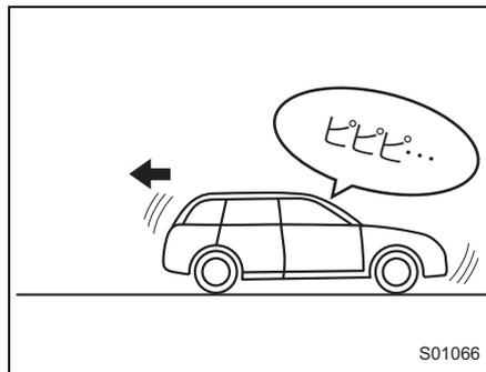
後退飛び出し抑制が作動すると、ブザー（ピピピ…）が鳴ります。また、マルチインフォメーションディスプレイに割り込み画面を表示します。
