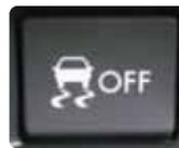
マルチモードVDCの制御モードを切り替えるときに使用します。
