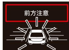
**AT誤後進抑制制御** セレクトレバーが **R** でブレーキを踏んでいないとき作動します。
