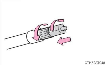
ボトルのホース先端に空気逃がしキャップを取り付ける
