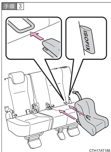
ISO FIX 固定バーの位置を確認して、チャイルドシートをシートに取り付ける
