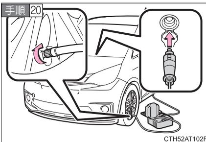
走行後、ボトルのホースから空気逃がしキャップを取りはずし、再度タイヤパンク修理キットを接続する
