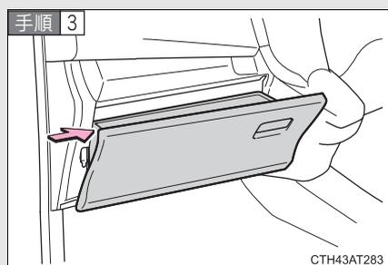
グローブボックス車両外側面を内側に押し、上部のツメをはずす
