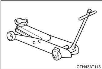
● 図のようなガレージジャッキを使用して車両を持ちあげる
