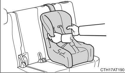
取り付けしたチャイルドシートを軽くゆさぶり、確実に取り付けられていることを確認する
