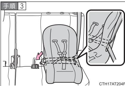
チャイルドシートにシートベルトを取り付け、プレートをバックルに“カチッ”と音がするまで差し込む。ベルトがねじれていないようにする
