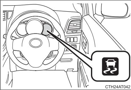
VDC、TRC※が作動しているときはVDC作動表示灯が点滅します。
