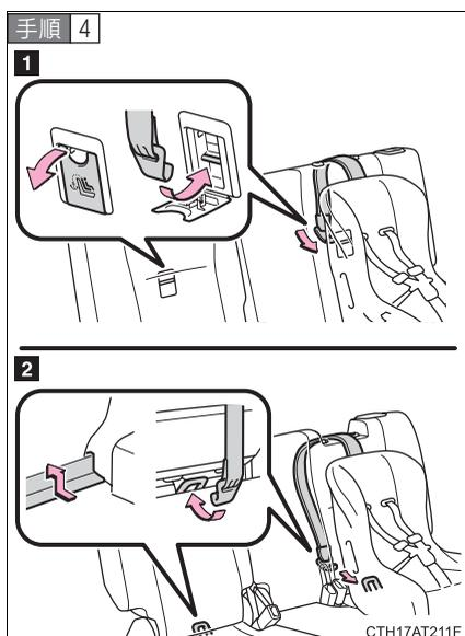
テザーアンカーにフックを固定し、テザーベルトを締める
