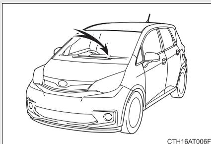
プッシュエンジンスイッチをOFFにすると、システムの作動を知らせるためにインジケーターが点滅します。
