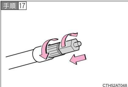
ボトルのホース先端に空気逃がしキャップを取り付ける
