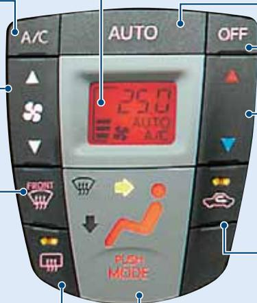
**マニュアルエアコン**
