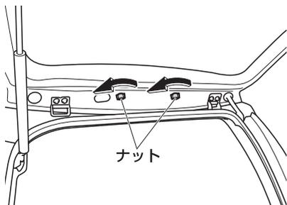
3. 矢印の方向にツメを押して、ランプ本体をリヤ ゲートから浮かせます。
