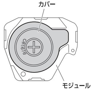
4. 矢印の方向にスライドさせて、電池を取り出し、新しい電池と交換します。
