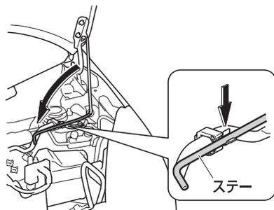
2. ボンネットを静かに下げ、手で押さえるようにして閉めます。
