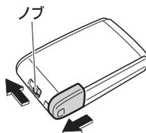
2. アクセス キーのノブを矢印の方向にスライドさせたまま、カバーを外します。
