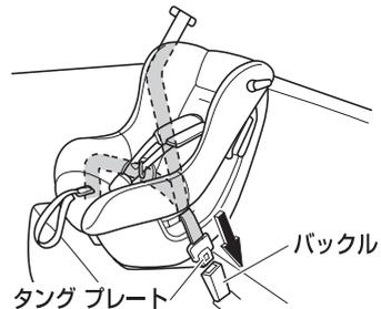
3. バックルの中にタング プレートを「カチッ」と音がするまで差し込みます。
