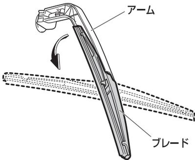
3. ブレードを矢印の方向に引いて、アームからブレードを引き抜きます。
