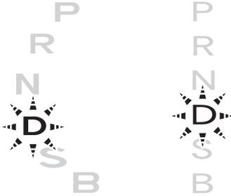
エンジン スイッチが“ON”の位置で、CVTシステムに異常があるとシフト セレクト インジケータの“D”の位置が点滅します。
