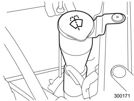
キャップを外し、キャップに付いているレベルゲージで液量を点検します。
