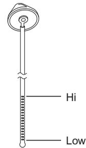
レベルゲージ下部の穴(レベル)に液量の膜が付着していることを確認してください。
