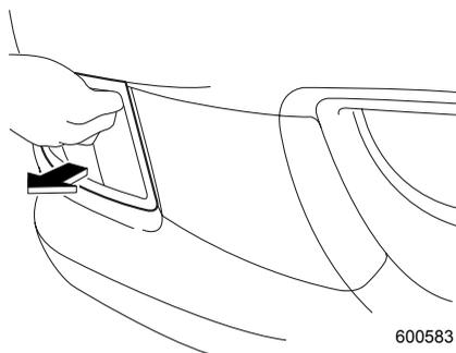
もしカバーの取り外しが困難ならば、バンパーに傷がつかないようにマイナスドライバーの先端をビニールテープや布で覆い、カバーの切りかきに差し込み、てこの原理でカバーを取り外してください。
