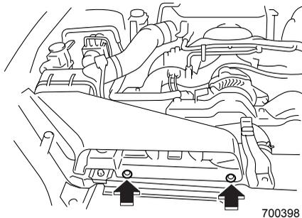
助手席側の電球を交換するときは、バッテリーカバー (装着車) を外します。次にウォッシャータンクのクリップを外し、注入口を倒して作業してください。
