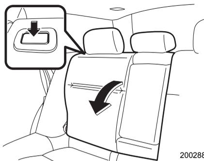
リモコン可倒機能付車は、荷室の左右にあるスイッチを引くと背当てが前に倒れます。
