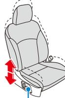
スイッチの後側を上下に動かす。(シートの高さ調整)
