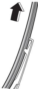
4. ワイパーブレードに新品のブレードラバーを挿入します。このとき、ブレードラバーの溝部にワイパーブレードのツメ部が挿入されていることを確認します。適切に装着されていないとワイパー作動時、ガラス面に傷をつけるおそれがあります。
