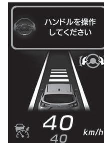
それでもシステムがハンドル操作を検知できなかった場合はハンドル操作要求の警告画面が表示され、ドライバー異常時対応システムが作動します。
