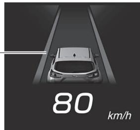
車線逸脱抑制機能は、次の条件をすべて満たすとスタンバイ状態になり、車線表示灯（白色）が点灯します。
