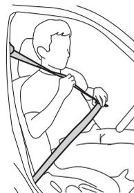
2. ベルトがねじれないようにし、タングプレートをバックルの中へ、“カチッ”と音がするまで差し込みます。
