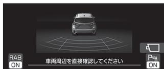
後退時ブレーキアシスト（RAB）が検知した障害物との距離の範囲を表示します。
