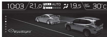
車線中央維持・先行車追従操舵機能 解除状態
