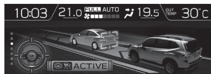
車線中央維持・先行車追従操舵機能 作動状態
