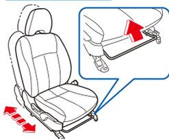
前席下部のレバーを完全に引き上げてシートを前後に動かします。
