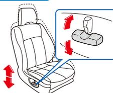
スイッチの後側を上下に動かしてシートの高さを調整します。
