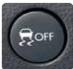
VDC (ビークルダイナミクスコントロール) システムを一時的に OFF にしたい場合に押します。作動可能状態に復帰させるときには、もう一度 VDC OFF スイッチを押します。
