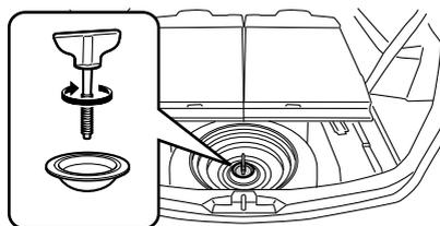
パンク修理後、応急用スペアタイヤを戻すときはスペーサーを必ず図の向きにしてネジを取り付けます。
