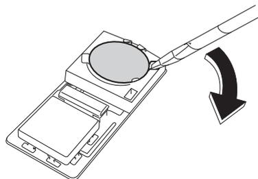
⑤新しい電池の⊕側を上にして図のように挿入し、カバーを確実に取り付けてください。
