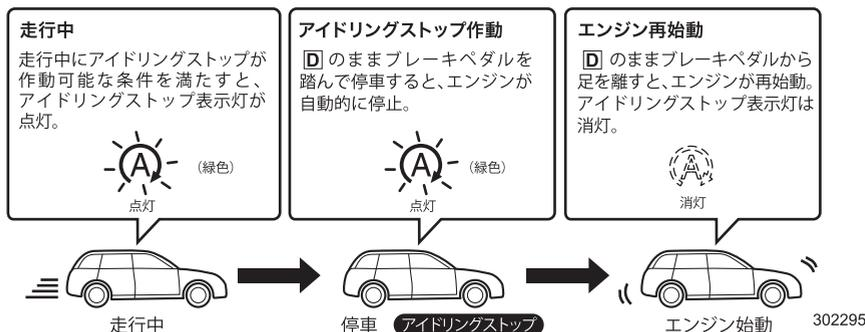
エンジン始動後、走行せずにアイドリングを続けた場合、アイドリングストップは作動しません。また、停車中にアイドリングストップ・再始動を繰り返すこともありません。アイドリングストップは短時間のアイドリング時にエンジンを自動で停止・再始動させる機能です。長時間の駐車時はエンジンスイッチをOFFにしてください。
