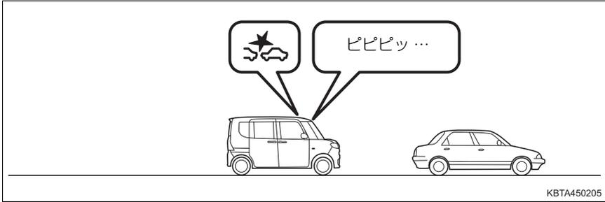
停止後にブザーが鳴り、ブレーキ制御を最長約 1.5 秒間継続したあと、ブレーキ制御を解除します。
