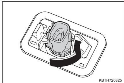
**4** 電球を取り外す
