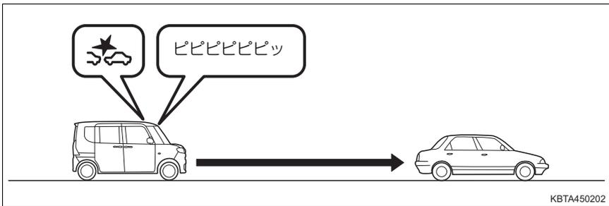
前方車両※・歩行者に対し、衝突の危険性があると判断したときに、ブザーとディスプレイの表示（→ P. 252）で運転者に注意喚起して衝突回避操作を促します。
