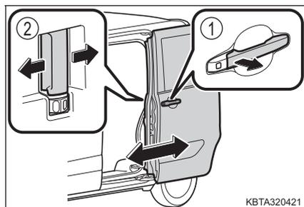
ロックが解除されるまで確実にドアハンドルを操作します。
