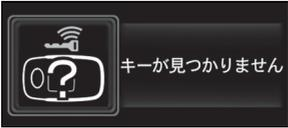
キーが見つかりません  | エンジンスイッチが“ACC”または“ON”のときにいずれかのドアを開けて、アクセスキーを車外に持ち出し、ドアを閉めた<br>・ 警告ブザーが鳴ります。<br>→ <b>アクセスキーを携帯して乗車する</b> |
