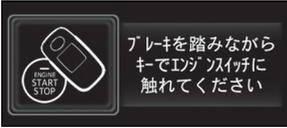
ブレーキを踏みながらキーでエンジンスイッチに触れてください | <p>アクセスキーを携帯していない状態で2回エンジンをかけようとした</p> <p>→ <b>アクセスキーを携帯する※1</b></p>                                                                                                                              |
