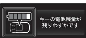
キーの電池残量が残りわずかです             | <p>アクセスキーの電池切れが近いときにエンジンスイッチを“OFF”にした※2</p> <ul style="list-style-type: none"> <li>警告ブザーが鳴ります。</li> </ul> <p>→ <b>新しい電池に交換する</b><br/>(→ P. 474)</p>                                               |
