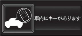
車内にキーがあります                    | <p>エンジンスイッチが“OFF”のときに、車内にアクセスキーを置いたまま、すべてのドアが施錠されている状態で運転席以外のドアのロックレバーを解錠側にして、ドアを開けて閉めた</p> <p>→ <b>アクセスキーを携帯して施錠する</b></p>                                                                       |
