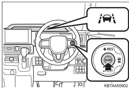
車線中央付近を走行中に作動条件（→ P. 320）をすべて満たすと LKC が作動します。
