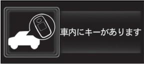
車内にキーがあります | タッチ&ゴーロック機能使用時、施錠操作をしたあとに、アクセスキーを車内に戻した<br>→ <b>車内からアクセスキーを取り出したあと、再度タッチ&amp;ゴーロック機能を使用する</b>           |
