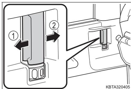
ロックが解除するまで確実にドアハンドルを操作します。
