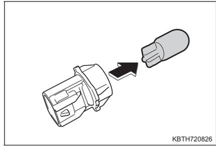
**5** 新しい電球を取り付け、ソケットを回してレンズに取り付ける
