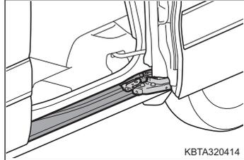
● 乗降時に、リヤシート下のプレートを踏まないようにしてください。プレート下の配線類が損傷するおそれがあります。
