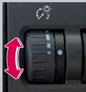
メーターなどの明るさを調整できます。上方向に回すと明るくなります。(ブライツ(減光キャンセル)機能)ダイヤルを一番明るい段階から、
