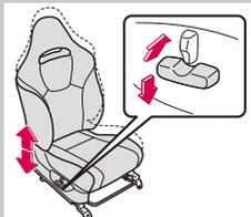
スイッチの後側を上下に動かしてシートの高さを調整します。
