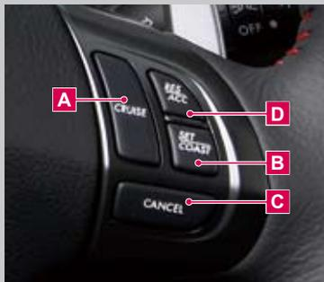
アクセルペダルを踏まなくても車速を一定に保つことができる機能です。CRUISE スイッチ **A** を押すとクルーズコントロールが作動可能になります。作動停止するときはスイッチをもう一度押します。
