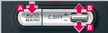
モード切り替えスイッチ **A** を押してオートモードとマニュアルモードを切り替えます。
