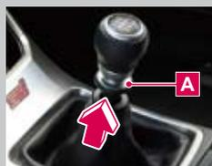
変速するときは、クラッチペダルをいっばいに踏み込んで確実に操作してください。「R」に入れるときはブルリング **A** を引き上げたままレバーを操作します。
