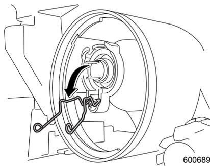
④ 電球を引き抜きます。
