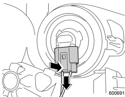
② ソケットを反時計回りに回し、ソケットを引き抜きます。
