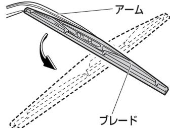
3. ブレードを矢印の方向に引いて、アームからブレードを引き抜きます。
