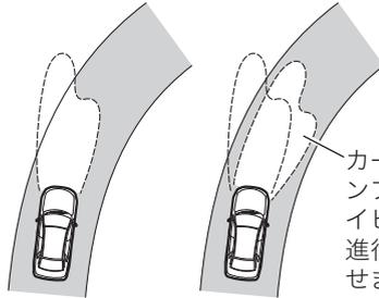
カーブに合わせてヘッドランプのロービームおよびハイビームの照射方向を変え、進行方向の視認性を向上させます。
