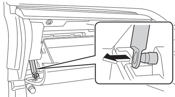
3. グローブボックスの両側面を内側に押し込んでストッパーを外し、グローブボックスを引き下げ、水平近くまで開いてからグローブボックスを取り外します。
