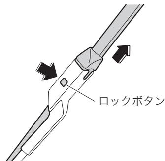
3. ワイパーアームが倒れないように支えながら、新品のワイパーブレードとアームの接続部を合わせ矢印の方向に押し込みます。
