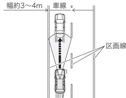
この機能は全車速追従機能付クルーズコントロールをセットしているときに使用できます。自車速0 km/h～約120 km/hで走行しているとき、システムが区画線または先行車を認識し、車両が車線の中央付近を維持するようにハンドル操作をアシストします。
