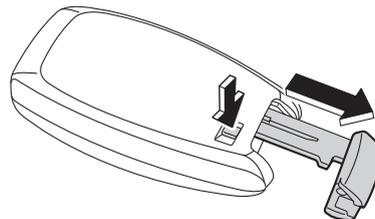
2. 溝部に絶縁テープなどを巻いたマイナスドライバーの先端を差し込んでカバーを外します。
