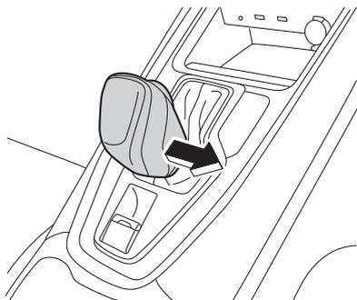
ギヤをアップするときは、パドルシフトレバーの右側の⊕レバーを手前に引きます。ギヤをダウンするときは、パドルシフトレバーの左側の⊖レバーを手前に引きます。ギヤ段は1速～8速です。自動変速に戻したいときは、セレクトレバーを“D”にします。
