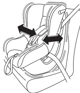
チャイルドシートにシートベルトの固定装置が備わっていない場合は、ロックングクリップを使用して固定します。取り付け後はチャイルドシートを軽く前後左右に動かし、確実に固定されていることを確認してください。
