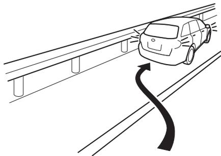
2. 同乗者をガードレールの外側などに避難させ、お車の50 m以上後方へ三角停止表示板と発炎筒を置くか、停止表示灯を使用してください。
