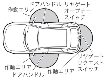
ドアが施錠している状態で前席のドアハンドルの作動エリアに入ると、アクセスキーのLEDの表示灯が点滅します。キーレスアクセス機能を停止させている場合は、アクセスキーのボタンを押さないとLEDの表示灯は点滅しません。
