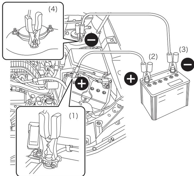
1. ⊕端子のカバーを外し、赤いブースターケーブルの一方を自車のバッテリーの⊕端子につなげます。(1)
