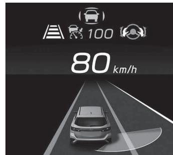
3. システムが車線変更可能と判断したら車線変更方向の車線表示灯が破線となり、隣の車線に進入するまで車線変更をアシストします。
