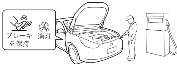
運転者が車内でブレーキペダルを踏んでいても、アイドリングストップ中にボンネットを開けると、安全を確保するためエンジンが完全に停止した状態になります。
