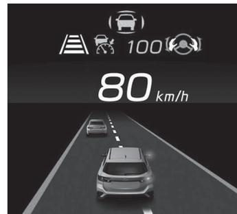
4. 隣の車線に完全に進入すると、車線中央維持・先行車追従操舵機能に移行し、方向指示器表示灯を自動消灯します。
