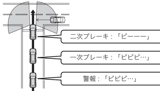
前側方から接近してくる車両（約5 km/h～約60 km/h）に次の順にシステムが作動し、運転者への注意喚起とブレーキ制御を行います。ブレーキ制御中は制動灯が点灯します。
