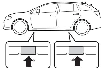
3. ジャッキ頭部の溝が車体のジャッキアップポイントにはまるまでジャッキハンドル取り付け部を手で回します。
