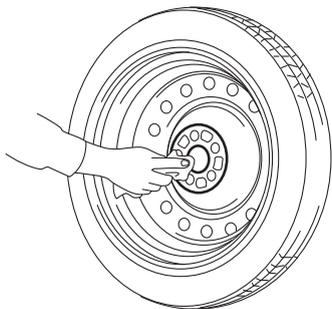
5. ホイールナットレンチを使用して、図の順番に2、3回にわけてホイールナットを締め付けます。
