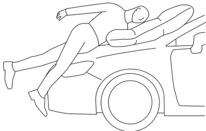
カウルパネルの「PEDESTRIAN PROTECTION AIRBAG」マークの記載があるところから展開します。
