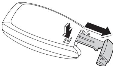
メカニカルキーを確実に差し込んでお車の後ろ側に回すと解錠され、前側に回すと施錠されます。メカニカルキーは差し込み方向に指定のある内溝キーです。差し込めない場合は向きを改めて差し込んでください。
