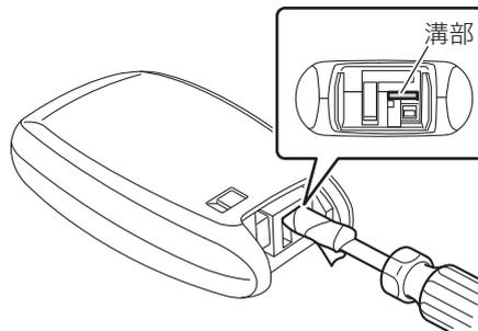
3. 電池と基板の間に絶縁テープなどを巻いたマイナスドライバーを差し込んで、電池の上側を押さえながら電池を抜き取ります。
