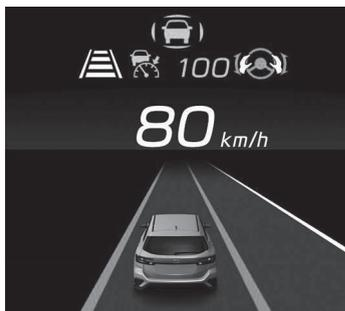
2. 走行している車線で1秒間待機し、システムが車線変更可能かを判断します。車線変更したい方向の隣車線の車両検知表示が点灯している場合は、車線変更できません。
