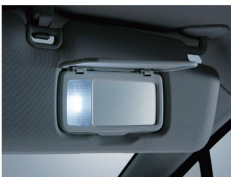
明るく長持ち。駐車作業中のバッテリーにも優しいLED室内灯。バルブ交換だけの手軽さも魅力。
