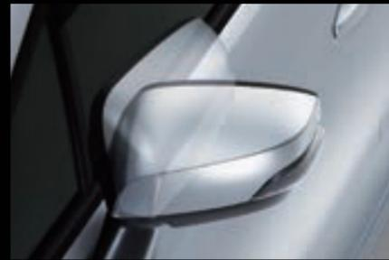
ドアミラーで後方確認しながら降車し、外からドアロックするとミラーを格納。キーレスの作動確認にもなります。
